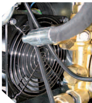
Вентилятор в корпусе насоса для дополнительного охлаждения насосного модуля и двигателя
